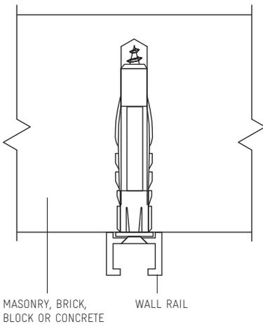
WALL PLUG FOR BRICK AND MASONRY
