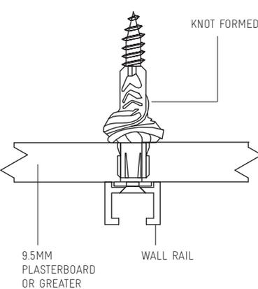
WALL PLUG FOR CAVITY WALLS
