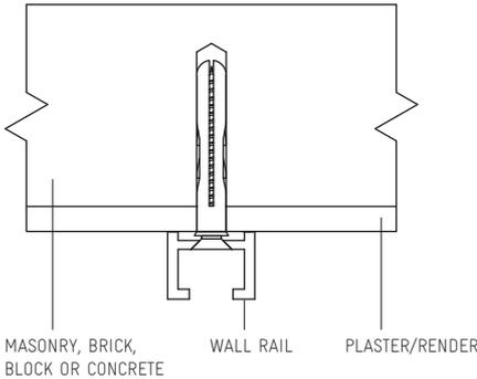
WALL PLUG FOR BRICK AND MASONRY
